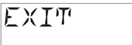
Wenn Sie innerhalb des Bedienmenüs die Taste **ON/OFF** kurz drücken, brechen Sie die Eingabe ab (ESC-Funktion) und kehren ohne Änderung zur Standardanzeige mit den zuletzt gespeicherten Einstellungen zurück.
